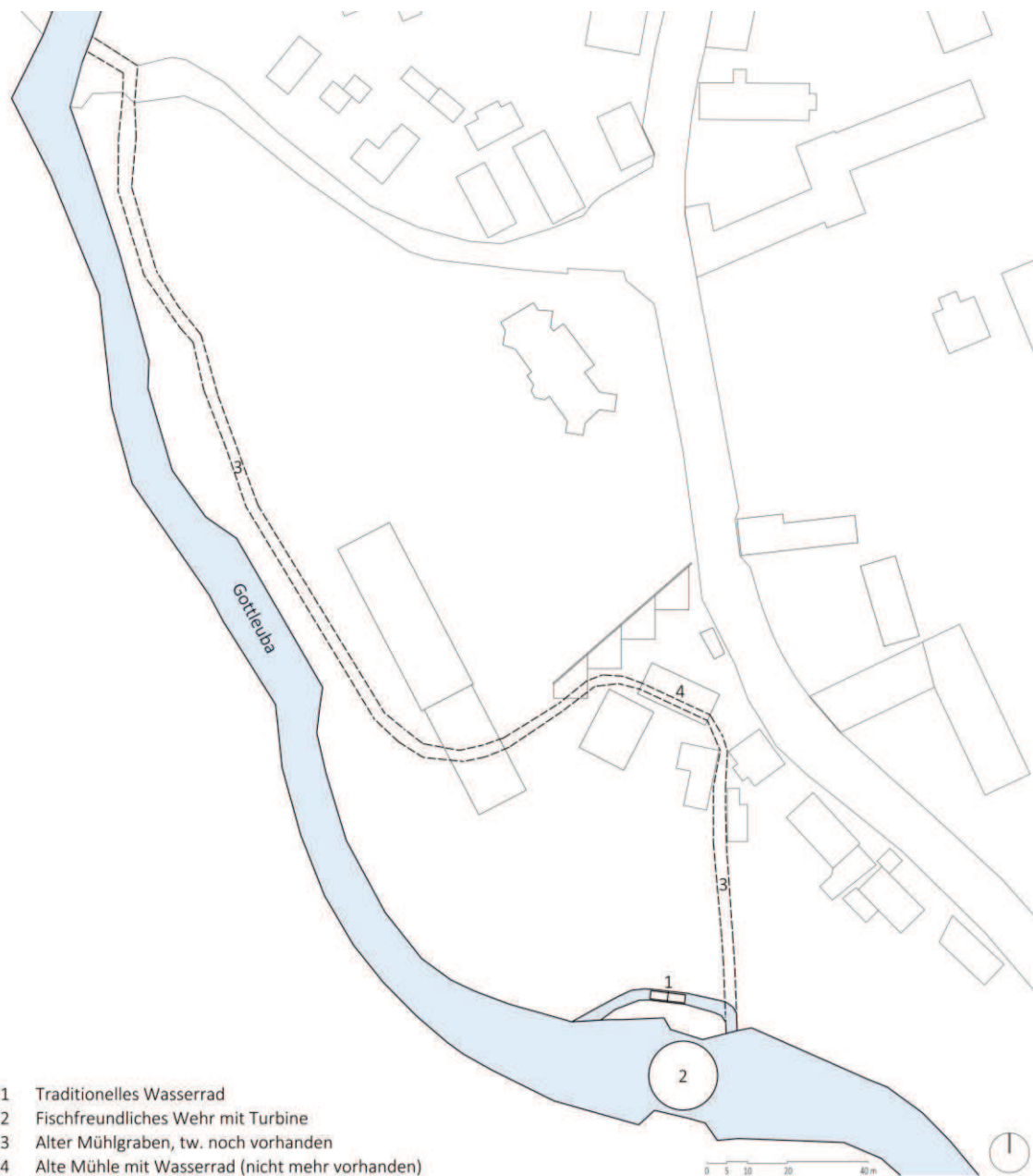
Abb. 26: Geplante und ehemalige Wasserkraftnutzung (Eigene Darstellung)
